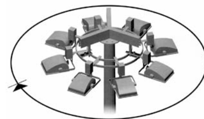
Oprawy rozmieszczone równomiernie po okręgu
